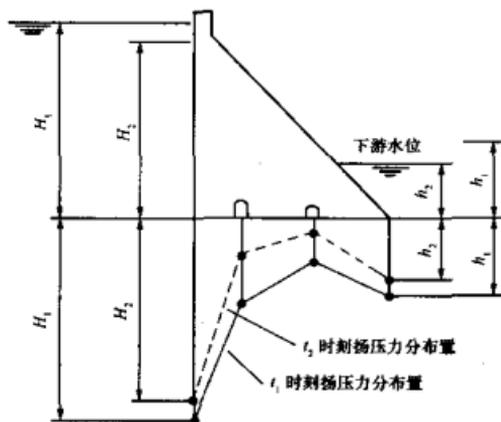
图 C.5 实测扬压力分布示意图
